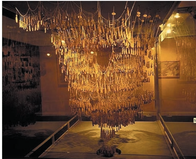
Figura I. Maquete do processo utilizado por Gaudí para o dimensionamento da igreja da Colônia Güell. Disponível em: < www.gaudidesigner.com/uk/sagrada-familia-funicular-model_357.html > Acesso em: 7 set. 2011.
