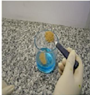
Etapa 2 - Adição de Biomassa à água colorida
