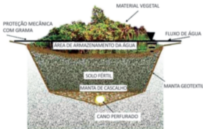
Figura 2. Detalhe esquemático de um jardim de chuva. Disponível em: http://criaarquitetura.com.br/jardins-de-chuva/ . Acesso em: 08 jun. 2023.
